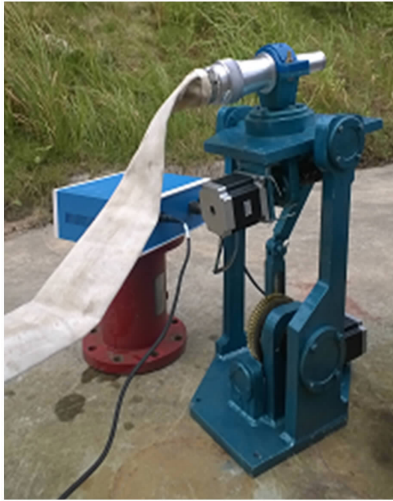
图7 基于混联结构的消防炮样机
