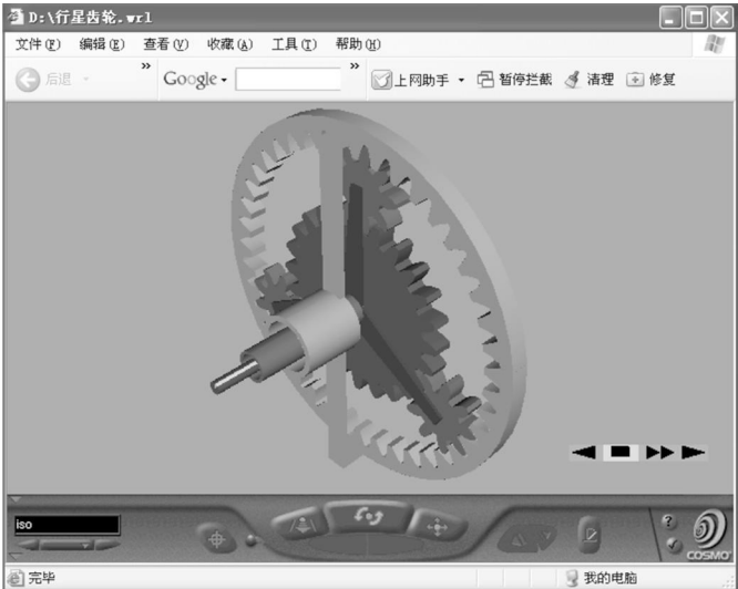
图 5 行星轮系机构运动仿真
