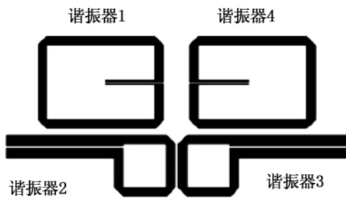
图7 高次谐波抑制的双带通准椭圆函数滤波器结构
