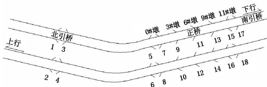
图2 九江长江大桥钢轨伸缩调节器布置示意图
