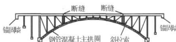
图1 钢管混凝土拉索拱桥桥型示意图
