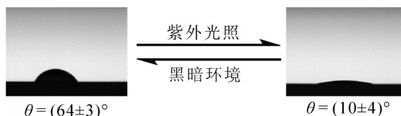
(a) 紫外光照射前(左)后(右)WO 3 薄膜的水珠在亲水和疏水之间转变的图片
