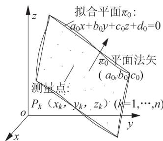
图1 基准平面拟合示意图
