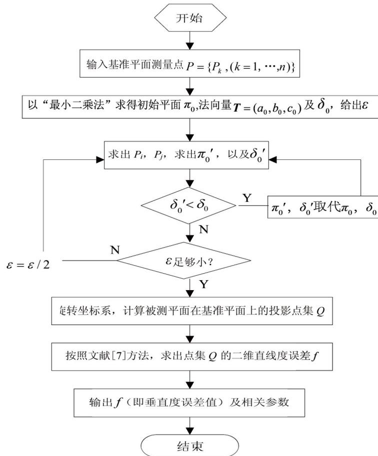
图4 垂直度算法流程图
