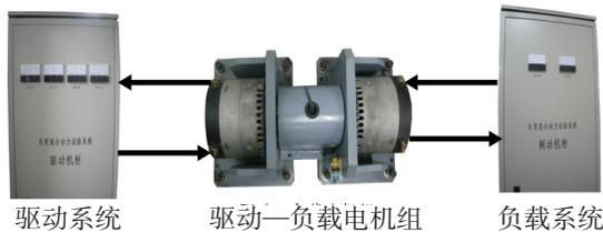
图1 试验系统结构图
