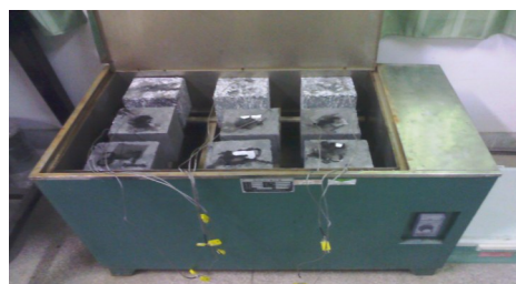
图1 普通混凝土和PCM混凝土的温度测试试验装置 Fig.1 Temperature test of concrete and PCM ancrete
