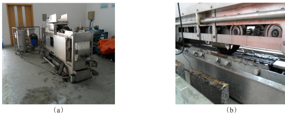
图1 小型加速加载仪MMLS13 Fig. 1 Small accelerated loading apparatus MMLS13
