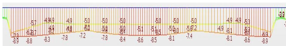
图6 T形截面标准压应力包络图
