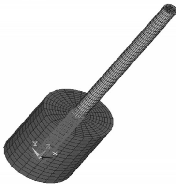
图1 桥墩-水流固耦合有限元模型
