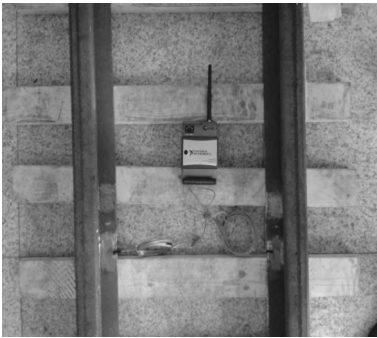
图 3 铂热温度传感器粘贴方式
