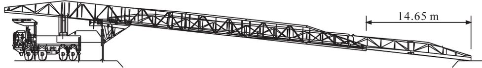
图2 大跨度拼装式桥梁沿导梁推送架设
