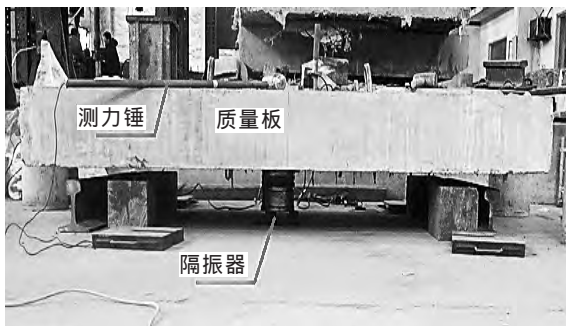
图 3 隔振器上放置质量块现场测试图
