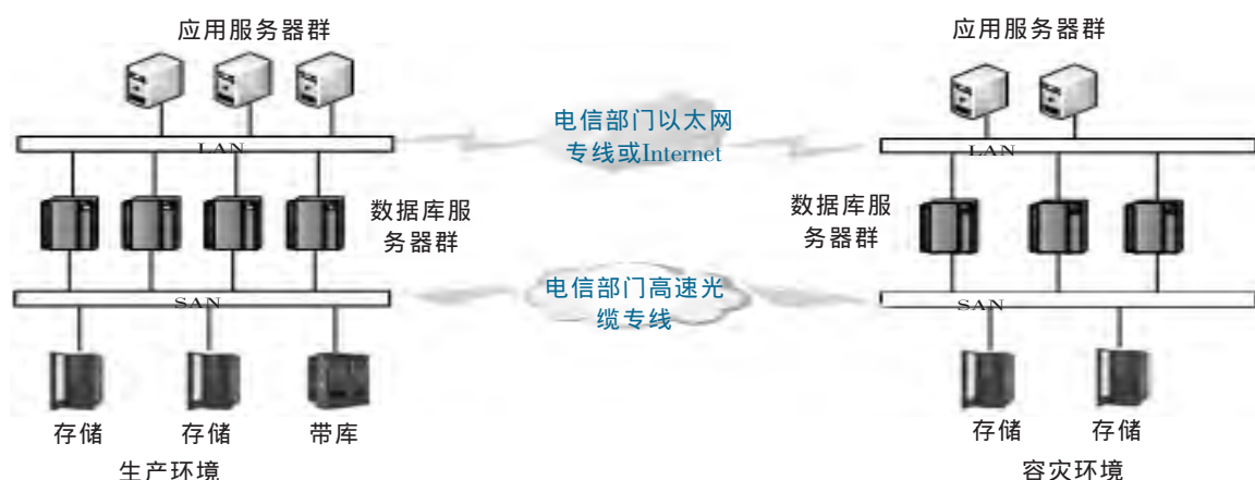
图 1 基于以太网/SAN 网络的操作系统级容灾原理
