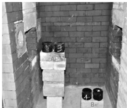
图 2 试验前试件在燃烧炉内的放置位置图 Fig.2 Position of specimen before test in the burner
