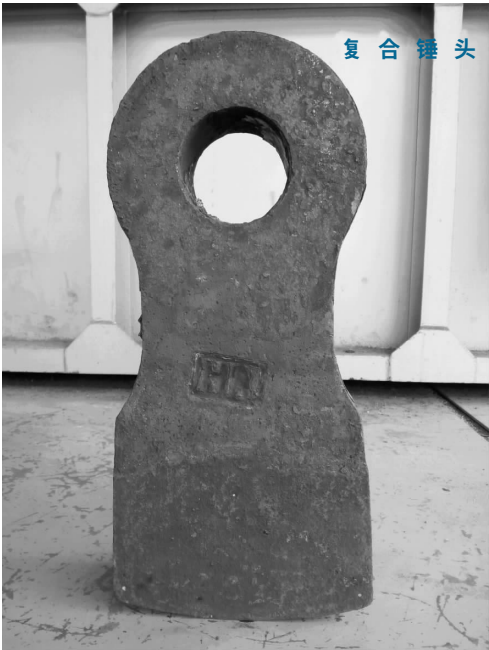
图 4 复合锤头实物 Fig.4 The composite hammerhead
