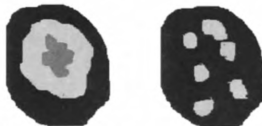
(a) 普通橡胶沥青(从外到内依次为沥青、凝胶、橡胶颗粒核心) (b) 脱硫橡胶沥青(从外到内是沥青、凝胶)
