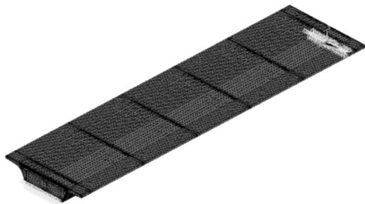
图 1 有限元模型网格划分图
