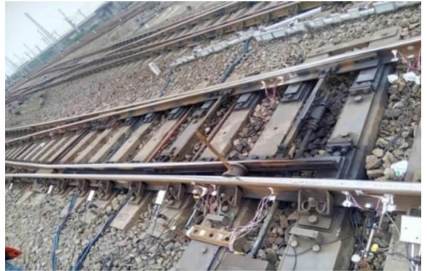
图 2 现场测点及传感器布置图
