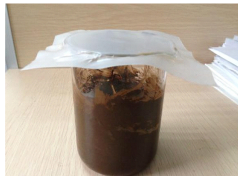
图 2 接触式滤纸法室内试验
