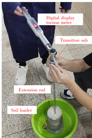
图2 不排水抗剪强度测试图 Fig.2 Undrained shear strength test
