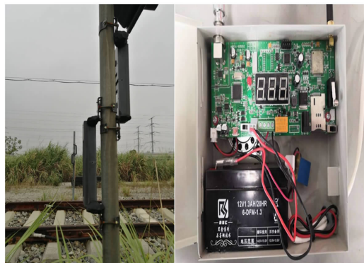
图 7 红外线防冒进装置结构
