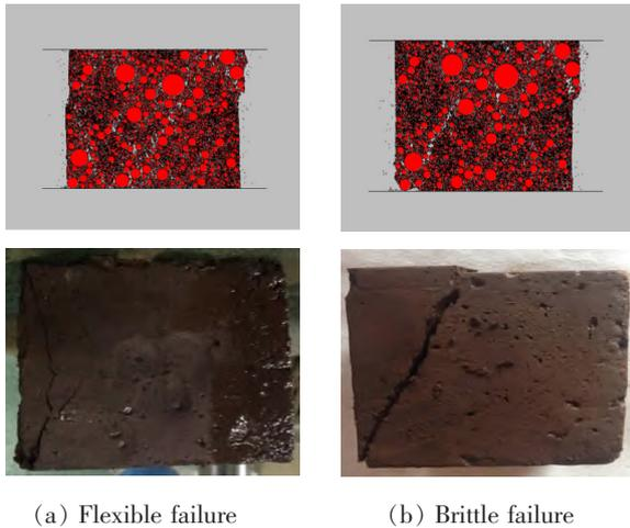
图 2 室内试验与数值模拟尾矿固化体破坏形态对比
