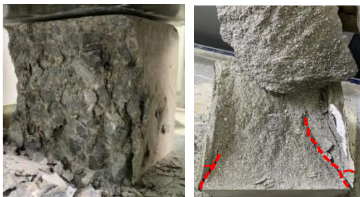
(a) CFA 取代率 50% (b) CFA 取代率 80%
