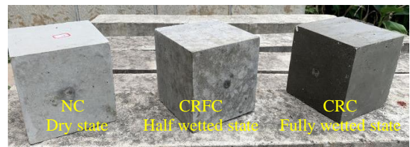
图 3 脱模后混凝土表面含水状态图
