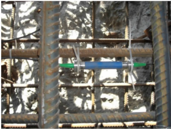
图2 预埋式光纤光栅应变传感器 Fig.2 Embedded FBG strain sensor
