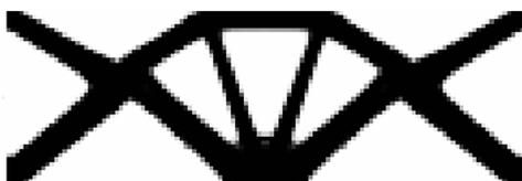
图 3 单相材料的结构拓扑图
