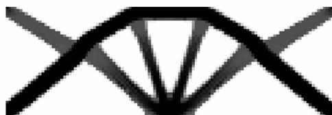
图 4 两相材料的结构拓扑图
