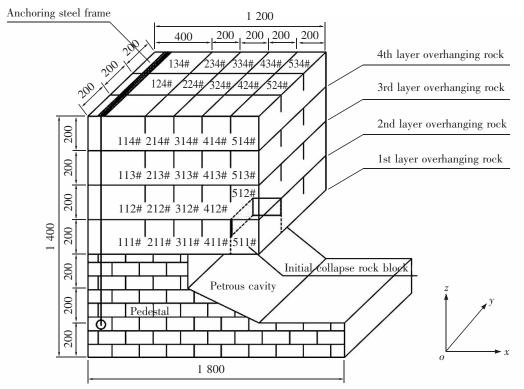
图 1 危岩集合体激振试验模型(单位:mm)
