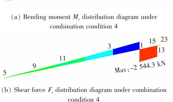
图 6 后锚式安装工况 4 盖梁内力分布图
