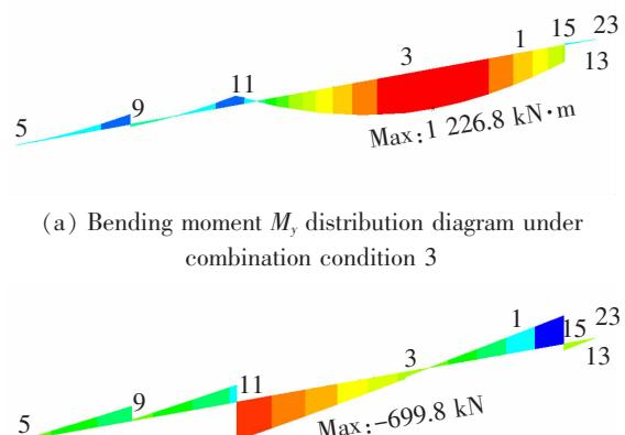
图 8 前支后锚式安装工况 3 盖梁内力分布图
