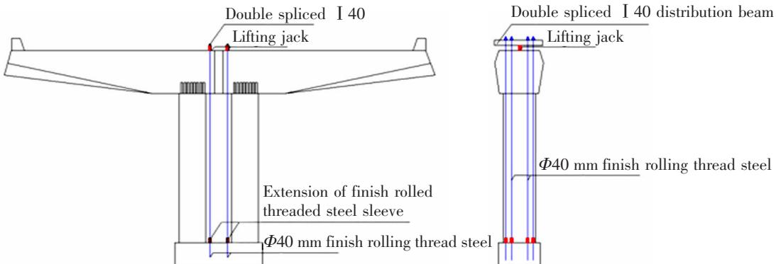
图1 拼接式盖梁后锚式安装图
