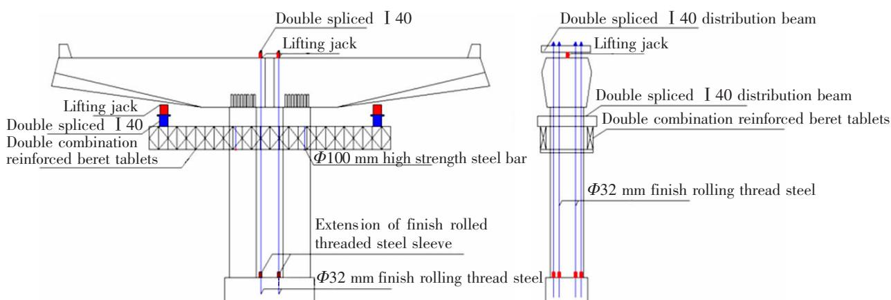
图2 拼接式盖梁前支后锚式安装图
