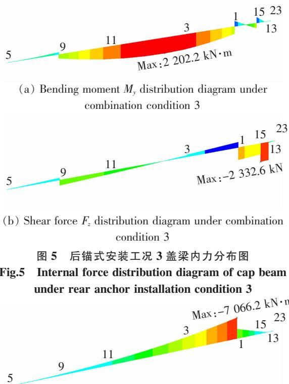
图 5 后锚式安装工况 3 盖梁内力分布图
