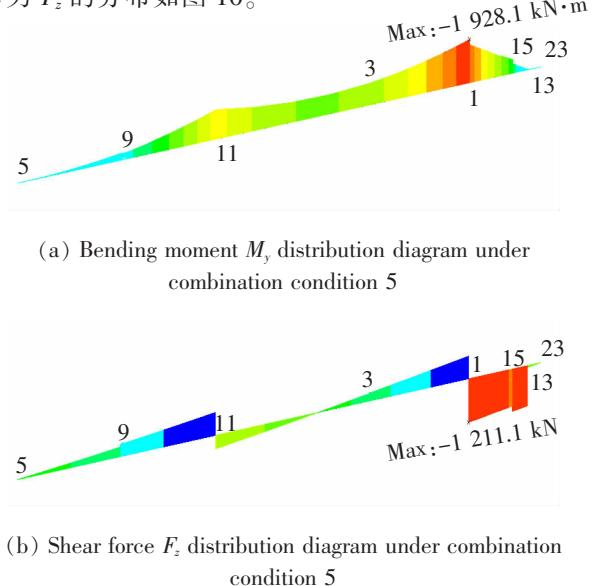
图10 前支后锚式安装工况5盖梁内力分布图
