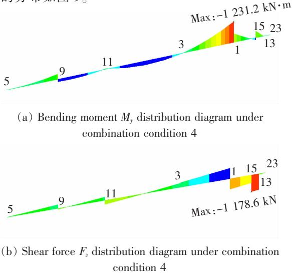
图9 前支后锚式安装工况4盖梁内力分布图
