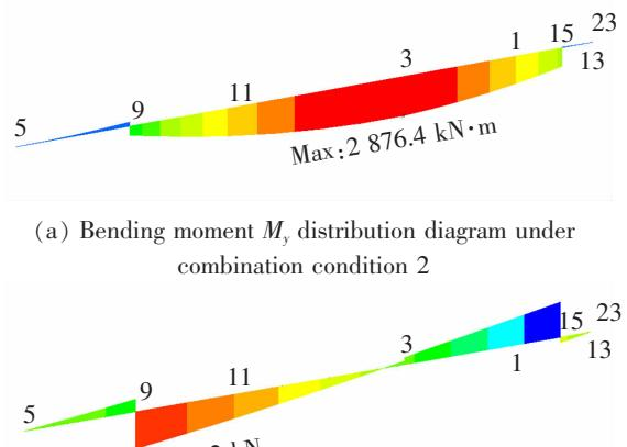
图 7 前支后锚式安装工况 2 盖梁内力分布图
