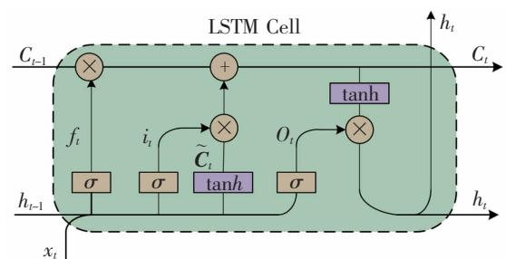
图 3 单个 LSTM 单元的内部结构
