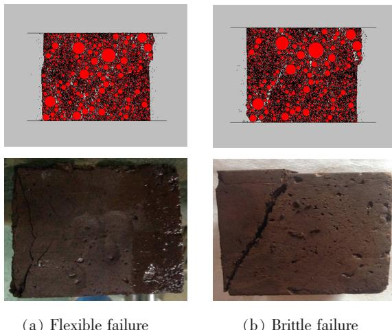
图2 室内试验与数值模拟尾矿固化体破坏形态对比
