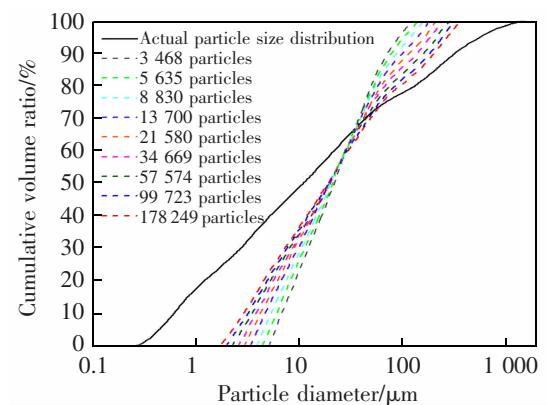
图3 不同尾矿颗粒数量对应的级配曲线
