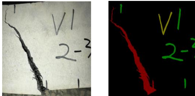
图 6 标签制作(a)原始图像(b)标签图像
