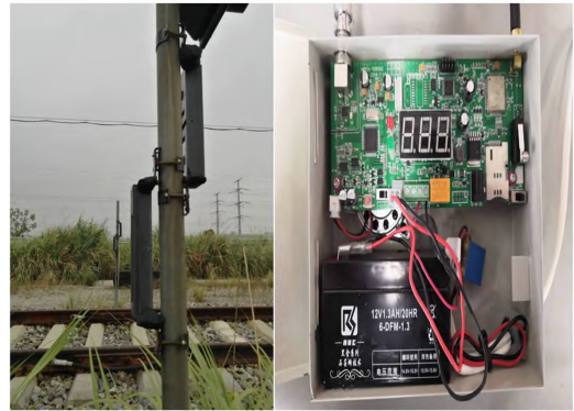
图 7 红外线防冒进装置结构
