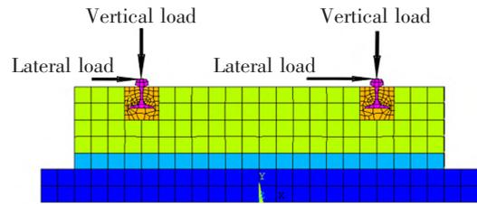
图 3 货车轴载作用位置
