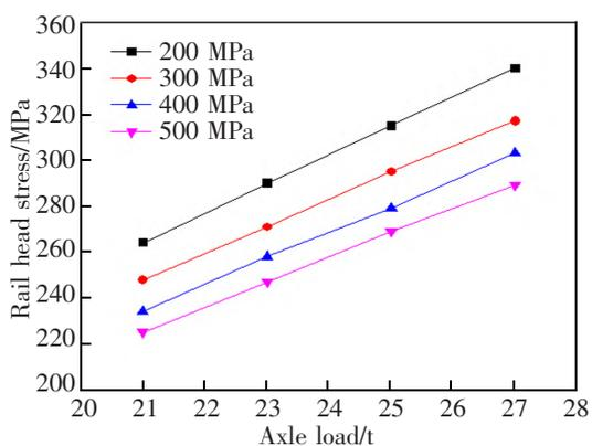
图5 轨头应力随弹性模量及轴载的变化
