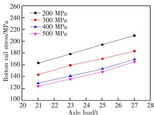
图6 轨底应力随弹性模量及轴载的变化
