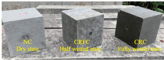
图3 脱模后混凝土表面含水状态图
