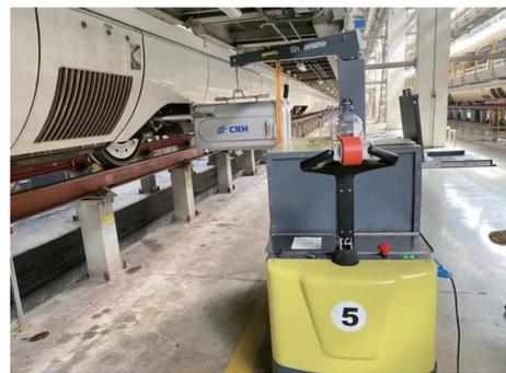
图7 空心车轴超声波裂纹检测系统
