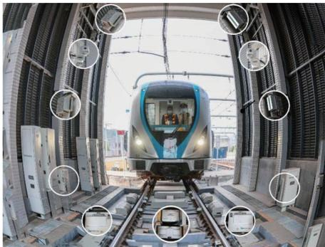
图5 360°列车外观图像检测系统
