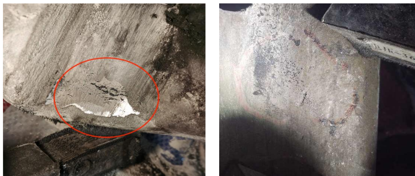
图3 钩舌挽面接触区损伤形貌
