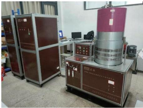
图3 ZTR-2000 微机控制岩石三轴测试系统
