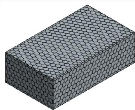
图 8 电池单体网格模型
