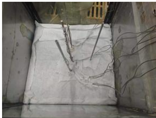
图 3 孔隙水压力计放入模型箱内
