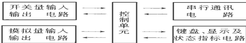
图1 控制系统硬件电路框图
