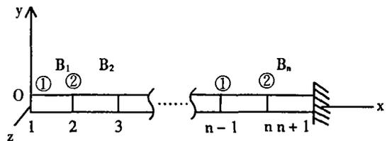
图 1 空心管的有限元模型
