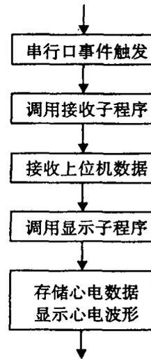
图4 PC机接收心电图数据流程图
