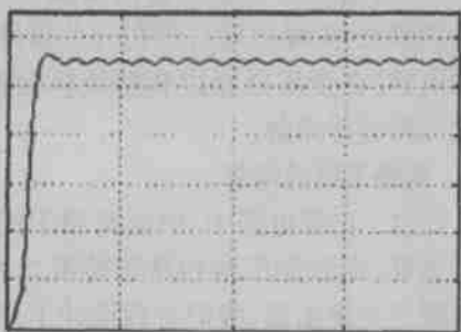
图 6 电源系统瞬态分析的 Pspice 仿真结果
