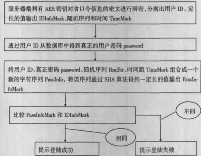
图 2 服务器端原理
