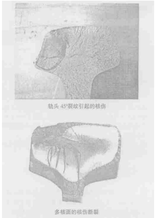
以 U71Mn 为例, 曲线半径为 1 000 m, 年通过运量为 52 Mt·km/km, 单向行车通过运量达到 15~20 Mt 时, 在曲线轨道外轨距侧的圆角处便出现微细裂纹(龟裂), 运量达到 30~50 Mt 后, 裂纹发展至作用边 25 mm 范围内产生 45°接触疲劳裂纹, 深度一般为 0.4~2.0 mm, 有明显的方向性(见照片 1)。当通过运量达到 150~200 Mt, 便在轨头内侧圆角处出现分散性剥离现象, 形状各异, 大小不等, 深度一般为 5~7 mm。由于各曲线所处位置, 坡道及轨道几何状态的不同, 有的地方剥离延续, 有的地方剥离稀疏(见照片 2)。剥离发展到一定程度, 一般在通过运量 250 Mt 以上时, 其裂纹深度增加, 横向互相贯通, 在轮轨力的作用下, 出现块状剥离掉块。随着通过总量的增加, 部分裂纹向深度发展, 形成重伤或核伤, 通过对鱼鳞重伤轨进行剖析, 有的裂纹深度达到 10 mm 以上。鱼鳞伤还常以裂纹尖端为源, 形成核伤(见照片 3)。有的甚至形成多核面的横向疲劳核断(见照片 4), 对行车安全构成严重威胁。
