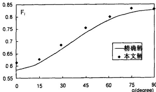
图 2 a/b = 2 时随圆裂纹的无量纲应力强度因子
