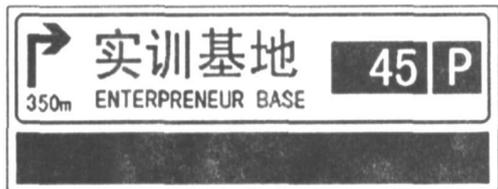
图 3 二级动态停车诱导发布屏示例图
