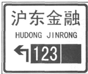
图 5 三级动态停车诱导发布屏示例图
