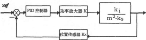
图 2 磁轴承闭环系统框图
